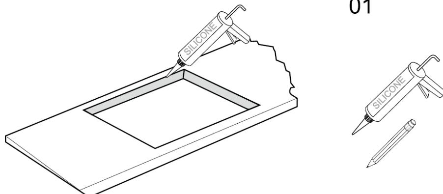
Сделайте выпил в столешнице, используя подходящее оборудование (рис. 1). Обработайте края выпила специальным силикатным герметиком. Дождитесь его высыхания.
