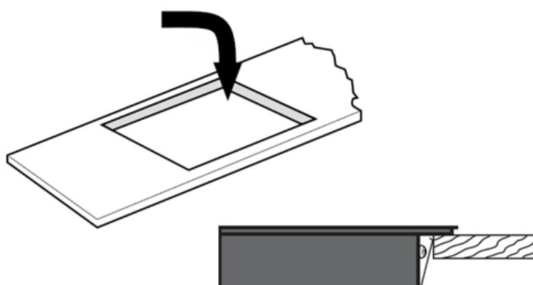
При установке варочной панели не используйте клей. После укладывания уплотнителя, поместите варочную панель в монтажное отверстие. Легко надавите. Убедитесь, что варочная панель установлена ровно и ее выступающие края плотно прилегают к поверхности столешницы (рис. 4).
