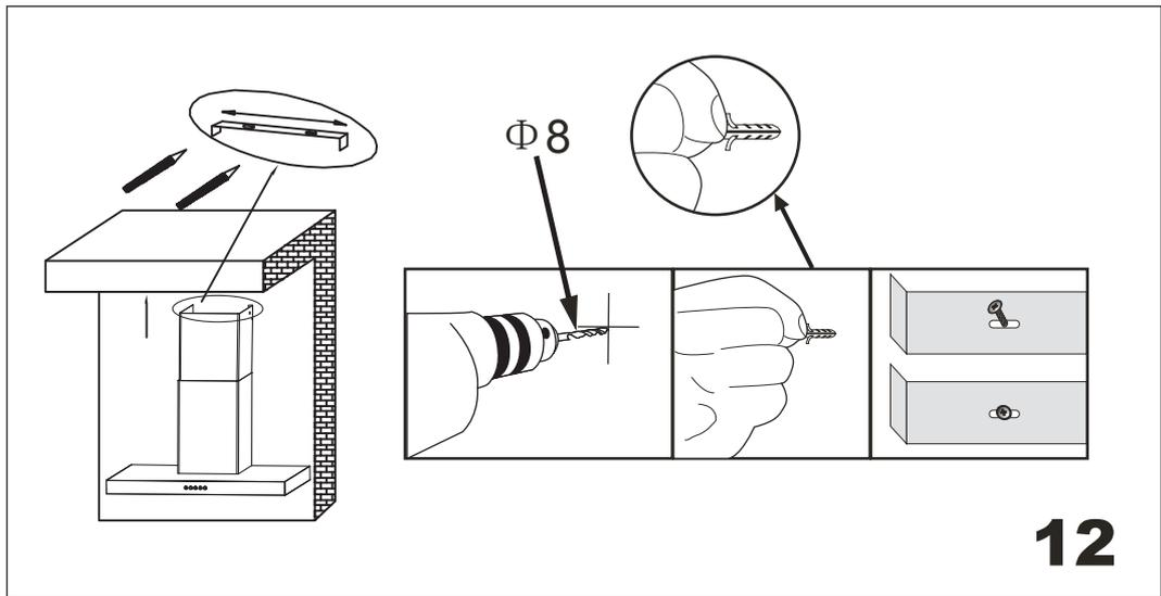
Установите неподвижную опору кожуха в соответствующее место на стене.
