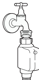
Заливной шланг с защитой от протечек
