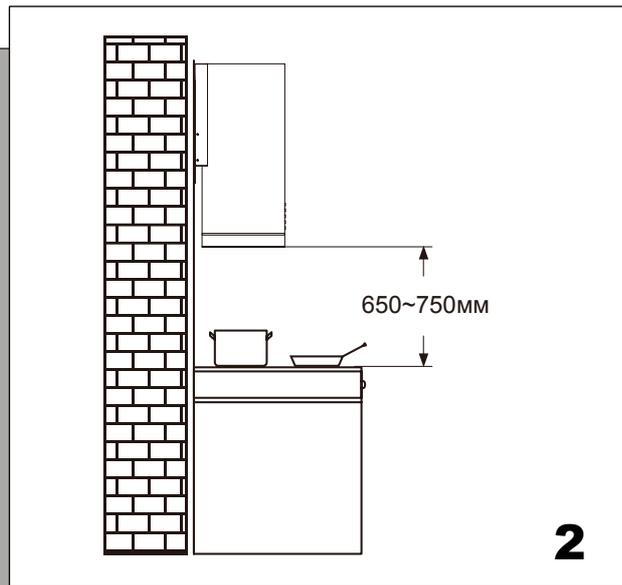
Рекомендуется, чтобы после установки нижняя часть вытяжки находилась не менее чем на 650 мм и не более чем на 750 мм выше нагревательных элементов печи и горелок.
