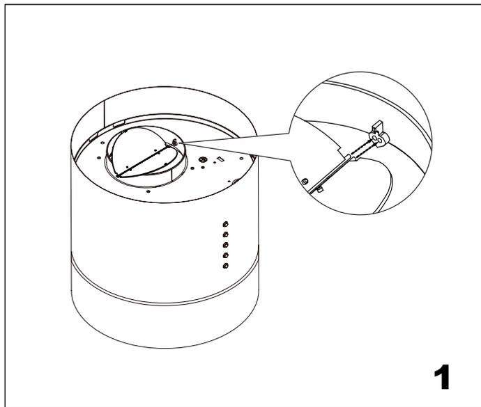
Монтаж и демонтаж обратного клапана.
